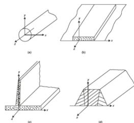
$$\begin{pmatrix} \sigma_x \\ \sigma_y \\ \tau_{xy} \end{pmatrix} = \frac{E}{(1+\mu)(1-2\mu)} \begin{bmatrix} 1-\mu & \mu & 0 \\ \mu & 1-\mu & 0 \\ 0 & 0 & \frac{1-2\mu}{2} \end{bmatrix} \begin{pmatrix} \epsilon_x \\ \epsilon_y \\ \gamma_{xy} \end{pmatrix}$$
