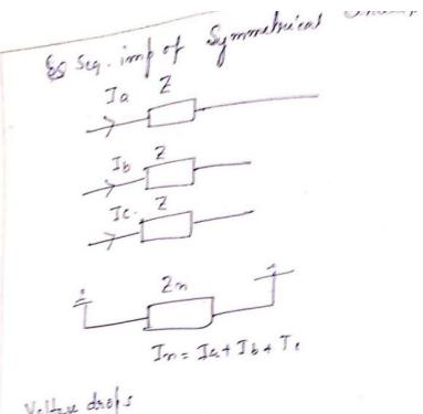
$$\begin{bmatrix} V_{a} \\ V_{b} \\ V_{c} \end{bmatrix}^{2} \begin{bmatrix} Z_{1} Z_{n} & Z_{n} & Z_{n} \\ Z_{n} & Z_{1} Z_{n} & Z_{1} \\ Z_{n} & Z_{n} & Z_{1} Z_{n} \end{bmatrix} \begin{bmatrix} J_{a} \\ J_{b} \\ J_{c} \end{bmatrix}$$
