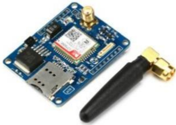
Fig 3.11 GSM sim 800C
