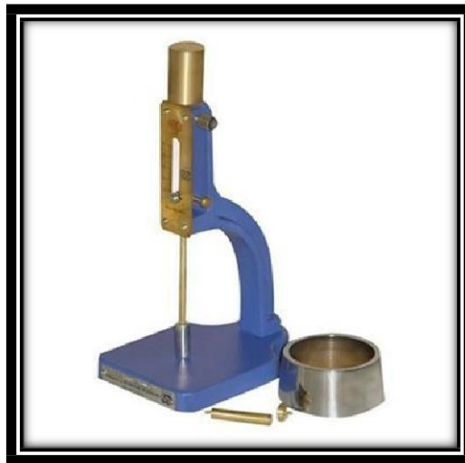
Fig 4.2.2.1(a) Vicat apparatus
