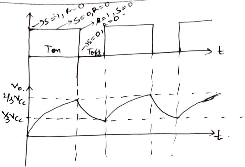
To find the  $T_{on}$  &  $T_{off}$ .
