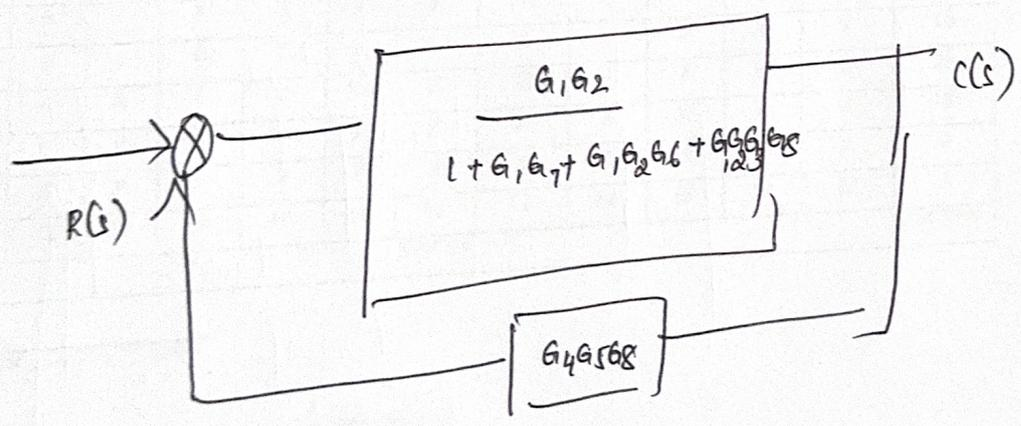
$$\frac{C(s)}{R(s)} = \frac{G_1 G_2}{1 + G_1 G_7 + G_1 G_2 G_6 + G_1 G_2 G_3 G_8 + G_1 G_2 G_4 G_5 G_8}$$
