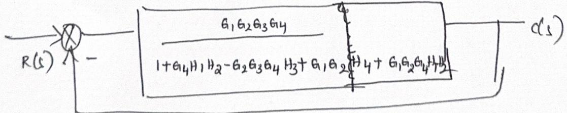
$$\frac{C(s)}{R(s)} = \frac{G_1 G_2 G_3 G_4}{1 + G_4 H_1 H_2 - G_2 G_3 G_4 H_3 + G_1 G_2 H_4 + G_1 G_2 G_4 H_1 H_2 + G_1 G_2 G_3 G_4}$$
